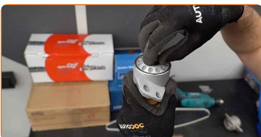
**19** Greifen Sie den Stoßdämpfer mit einem Schraubstock.
