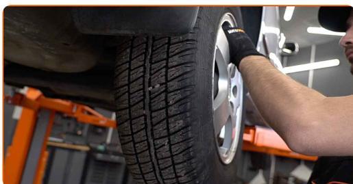
**6** Schrauben Sie die Befestigungselemente der Radkastenabdeckung heraus und entfernen Sie sie. Verwenden Sie den Torx T25.
