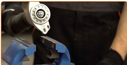
**22** Reinigen Sie die Stoßdämpferaufnahmen. Benutzen Sie eine Drahtbürste. Benutzen Sie WD-40-Spray.
