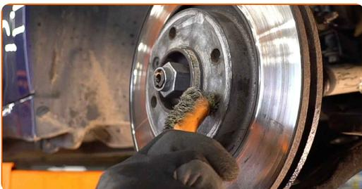
**18** Lösen Sie die Befestigung der Bremsscheibe. Verwenden Sie den Torx T30. Verwenden Sie einen Schlagschrauber.
