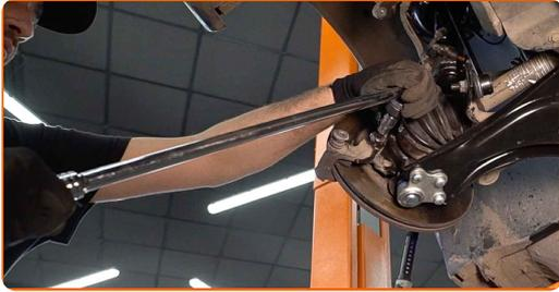
**16** Entfernen Sie die Sattelhalterung.
