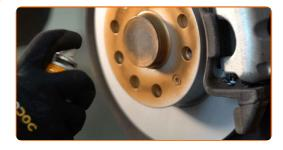
Die Bremsscheibenoberfläche reinigen. Benutzen Sie einen Bremsenreiniger.
