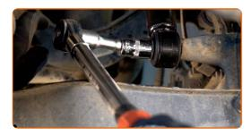
Entfernen Sie den Träger unter dem Arm.
