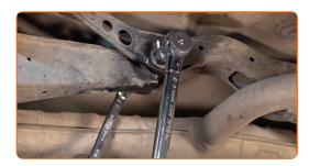
Reinigen Sie die Befestigung der Abgasanlage. Benutzen Sie WD-40-Spray.
