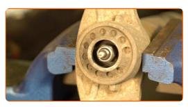
Reinigen Sie die Befestigungen vom Stoßdämpferschaft. Benutzen Sie eine Drahtbürste. Benutzen Sie WD-40-Spray.
