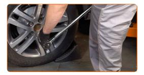
Entfernen Sie den Wagenheber sowie die Unterlegkeile.
