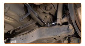
Schrauben Sie das obere Befestigungselement des Stoßdämpfers ab. Verwenden Sie Stecknuss Nr. 16. Verwenden Sie ein Windeisen.
