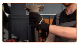
Schrauben Sie die untere Befestigung der Federbeinkolbenstange an. Verwenden Sie einen Stoßdämpfer Steckschlüsseleinsatz DDNº6. Verwenden Sie Stecknuss Nr. 17. Verwenden Sie einen Drehmomentschlüssel. Ziehen Sie ihn mit 25 Nm Drehmoment fest.
