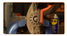
Entfernen Sie die Befestigung der Stoßdämpferkolbenstange. Verwenden Sie einen Stoßdämpfer Steckschlüsseleinsatz DDNº6. Verwenden Sie Stecknuss Nr. 17. Verwenden Sie einen Ratschenschlüssel.
