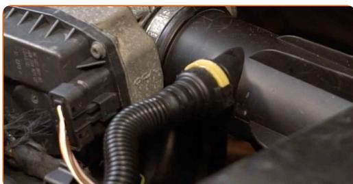
**19** Ziehen Sie die Klemme am Luftansaugschlauch fest. Verwenden Sie Stecknuss Nr. 7. Verwenden Sie einen Ratschenschlüssel.
