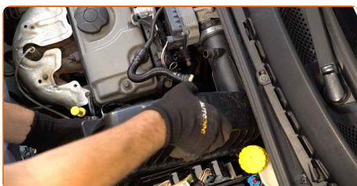
**17** Schrauben Sie die Filtergehäuse-Befestigungsbolzen an. Verwenden Sie Stecknuss Nr. 10. Verwenden Sie einen Ratschenschlüssel.
