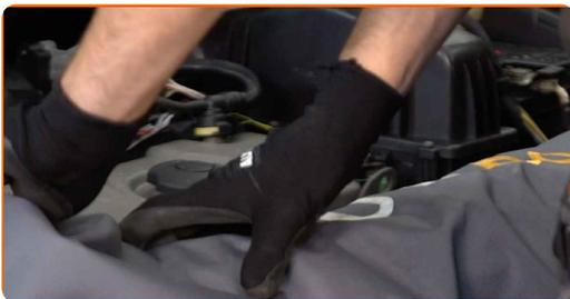
**3** Lösen Sie die Luftansaugschlauchklemme. Verwenden Sie Stecknuss Nr. 7. Verwenden Sie einen Ratschenschlüssel.
