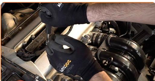
**7** Entnehmen Sie die Zündspule aus der Vertiefung für die Zündkerze.
