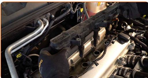
**8** Entfernen Sie Schmutz, Staub und Ablagerungen von den Zündkerzenbohrung. Schrauben Sie die Zündkerzen heraus. Verwenden Sie die Zündkerzennuss # 16. Verwenden Sie einen Ratschenschlüssel.
