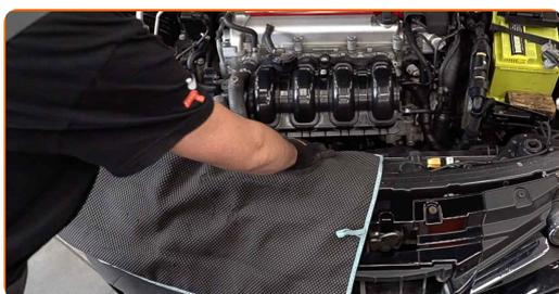
**3** Lösen Sie die Schrauben der Motorabdeckung (4 Stück). Verwenden Sie Stecknuss Nr. 8. Verwenden Sie einen Ratschenschlüssel.
