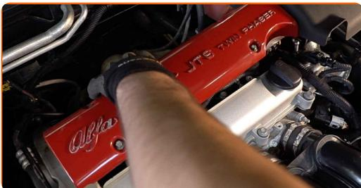
**5** Ziehen Sie den Anschluss der Zündspule ab. Verwenden Sie einen flachen Schraubendreher.
