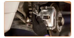
Verbinden Sie den Schlauch des Bremsentlüftungs-Kits mit der Bremsentlüftungsschraube.
