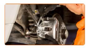
Entfernen Sie die Klammer des Bremsschlauchs.
