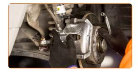
Behandeln Sie die Oberfläche, an der die Bremsscheibe die Felge berührt. Verwenden Sie Hochtemperatur-Keramikfett.
