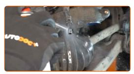
Installieren und fixieren Sie den Bremsschlauch in einen neuen Bremssattel. Verwenden Sie einen offenen Ringschlüssel #14.
