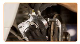
17 Installieren Sie den Bremssattel und fixieren Sie diesen.
