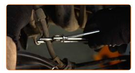
Lösen Sie die Bremsentlüftungsschraube. Verwenden Sie Ring-Gabelschlüssel Nr. 9.
