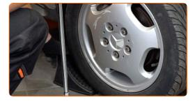
Lösen Sie die Radhalterungsschrauben. Verwenden Sie eine Schlagnuss für Felgen # 17.
