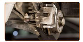
Schrauben Sie die Befestigung des Bremssattels ab. Verwenden Sie Ring-Gabelschlüssel Nr. 15. Verwenden Sie Stecknuss Nr. 13. Verwenden Sie einen Ratschenschlüssel.
