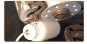
Entlüften Sie das Bremssattelsystem.
