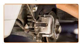
Lösen Sie die Bremsschlauchbefestigung. Verwenden Sie einen offenen Ringschlüssel #14. 9
