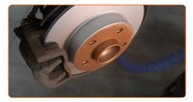
Die Bremsscheibenoberfläche reinigen. Benutzen Sie einen Bremsenreiniger.
