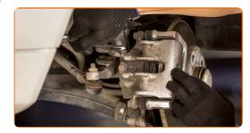
Die Bremssattelbefestigungen reinigen. Benutzen Sie eine Drahtbürste. Benutzen Sie WD-40-Spray. 10
