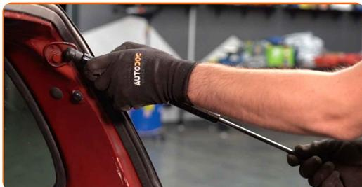
Austausch: Heckklappendämpfer – Renault Twingo C06. AUTODOC-Experten empfehlen:
