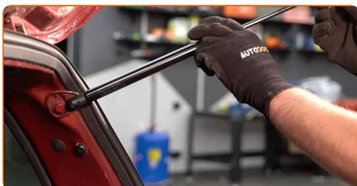
**8** Lassen Sie den Sprengring, der die Gasfeder mit dem Kofferraumdeckel verbindet, einrasten.
