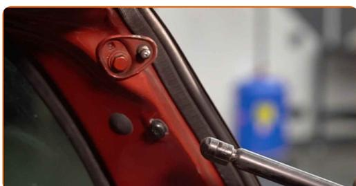
**6** Bringen Sie die neue Gasfeder des Kofferraumdeckels an.
