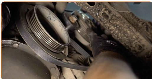
**12** Legen Sie den Keilrippenriemen auf die Kurbelwellenriemenscheibe. Verwenden Sie Stecknuss Nr. 18. Verwenden Sie einen Ratschenschlüssel.
