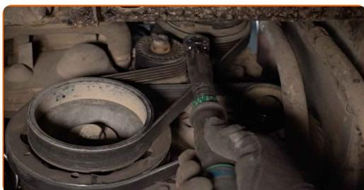
**18** Ziehen Sie die obere Befestigung der Lichtmaschine an. Verwenden Sie Stecknuss Nr. 13. Verwenden Sie einen Drehmomentschlüssel. Ziehen Sie ihn mit 20 Nm Drehmoment fest.
