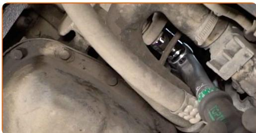
**19** Ziehen Sie die untere Befestigung der Lichtmaschine an. Verwenden Sie Stecknuss Nr. 16. Verwenden Sie einen Drehmomentschlüssel. Ziehen Sie ihn mit 35 Nm Drehmoment fest.
