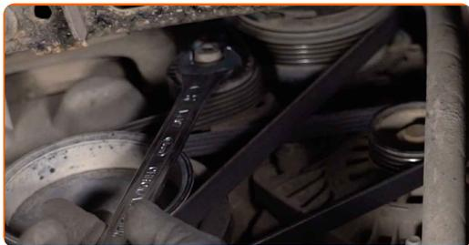
**17** Drehen Sie das Befestigungselement der Spannrolle des Klimakompressors ein. Verwenden Sie Ring-Gabelschlüssel Nr. 21. Verwenden Sie Inbusschlüssel Nr. H7.
