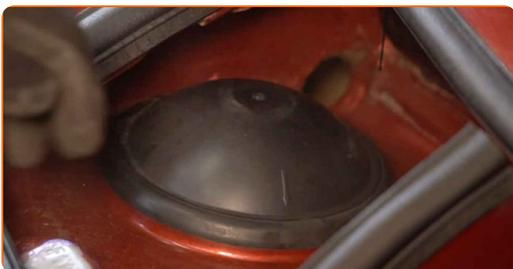
**50** Entfernen Sie die Kotflügel-Abdeckung.
