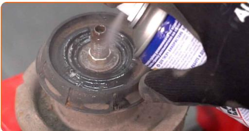
**21** Entfernen Sie die Stangenmutter des Federkolben. Verwenden Sie Stecknuss Nr. 17. Verwenden Sie Inbusschlüssel Nr. H6. Verwenden Sie einen Ratschenschlüssel.
