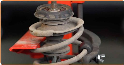
**20** Behandeln Sie die Federbeinstange. Benutzen Sie eine Drahtbürste. Benutzen Sie WD-40-Spray.
