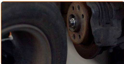
**11** Die Befestigungselemente, die das Federbein mit dem Achsschenkel verbinden, reinigen. Benutzen Sie eine Drahtbürste. Benutzen Sie WD-40-Spray.
