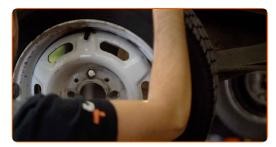
Reinig de remtrommel. Benutzen Sie eine Drahtbürste. Benutzen Sie WD-40-Spray.
