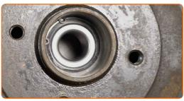
Reinigen Sie den Einbauort für die Nabenlagerung. Verwenden Sie Allzweckreinigungsspray.
