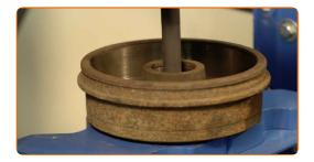
Reinigen Sie den Einbauort für die Nabenlagerung. Benutzen Sie WD-40-Spray.
