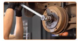
10 Entfernen Sie die Bremstrommel.
