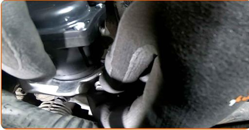
**13** Schrauben Sie die Befestigungen des AGR-Ventils fest. Verwenden Sie Stecknuss Nr. 8. Verwenden Sie einen Drehmomentschlüssel. Ziehen Sie ihn mit 9 Nm Drehmoment fest.
