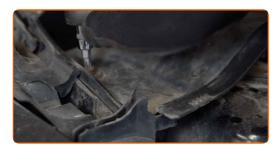
Entfernen Sie die untere Windlaufabdeckung.
