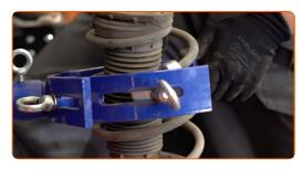
Entfernen Sie die Stangenmutter des Federkolben. Verwenden Sie den Torx T40. Verwenden Sie Ring-Gabelschlüssel Nr. 19. Verwenden Sie einen Ratschenschlüssel.
