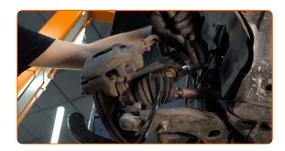
Ziehen Sie den Achsschenkel vom Dämpferbein ab. Benutzen Sie ein Brecheisen. 23
