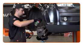
Installieren Sie das Federbein am Radlauf.
