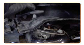
Bringen Sie die Befestigungselemente der Windlaufabdeckung an.
