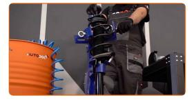
Entfernen Sie das zusammengebaute Federbein.
