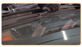
Ziehen Sie die Befestigungen der Wischerarme fest. Verwenden Sie Stecknuss Nr. 15. Verwenden Sie einen Drehmomentschlüssel. Ziehen Sie ihn mit 10 Nm Drehmoment fest.
