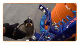
Installieren Sie die Feder am Stoßdämpfer.
