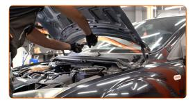
Entfernen Sie die Befestigungsclips der Windlaufabdeckung. Benutzen Sie ein Brecheisen.
