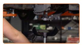
Lösen Sie das untere Befestigungselement, dass das Federbein mit dem Achsschenkel verbindet. Verwenden Sie eine spezielle Schraubnuss, um den Stoßdämpfer zu entfernen. Benutzen Sie einen Hammer. Verwenden Sie einen flachen Metallmeißel.
