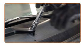
Reinigen Sie die Stifte der Frontscheibenwischerarme. Benutzen Sie WD-40-Spray.
