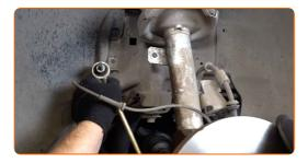
Schrauben Sie das untere Befestigungselement ab, dass das Federbein mit dem Achsschenkel verbindet. Verwenden Sie Stecknuss Nr. 18. Verwenden Sie einen Ratschenschlüssel. Verwenden Sie ein Windeisen.
