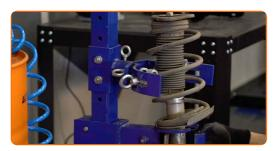
Reinigen Sie die Stoßdämpferstange. Benutzen Sie WD-40-Spray.
