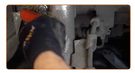
Schrauben Sie die Mutter ab und entfernen Sie die Stabilisatorstange aus dem Federbein. Verwenden Sie Stecknuss Nr. 15. Verwenden Sie einen Ratschenschlüssel.
