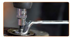
Entfernen Sie das obere Federbein. Benutzen Sie ein Brecheisen.
