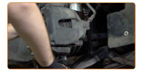
Schrauben Sie die untere Befestigung der Stoßdämpferstrebe ab.
