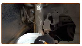
Reinigen Sie die Befestigungselemente, welche den Stabilenker mit dem Federbein verbinden, sowie die, welche das Federbein mit dem Achsschenkel verbinden. Benutzen Sie eine Drahtbürste. Benutzen Sie WD-40-Spray.
