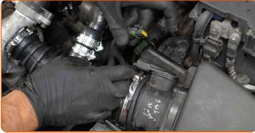
**14** Entfernen Sie das Luftfiltergehäuse.
