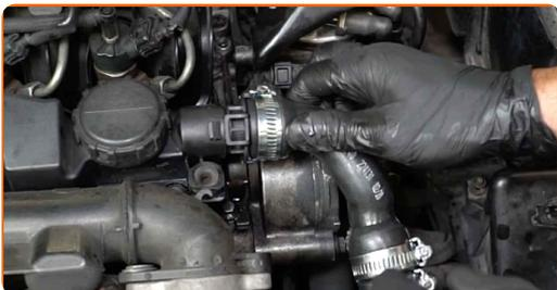
**34** Ziehen Sie die Klemme am Luftansaugschlauch fest. Verwenden Sie Stecknuss Nr. 7. Verwenden Sie einen Ratschenschlüssel.
