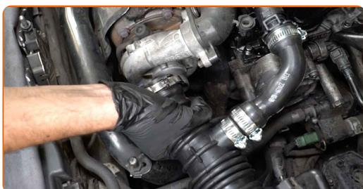
**13** Lösen Sie den Steckverbinder des Luftmassenmessers.
