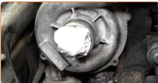
**16** Decken Sie das PCV-Ventilloch mit einem Mikrofasertuch ab, um zu verhindern, dass Schmutz und Fremdkörper in das System gelangen.
