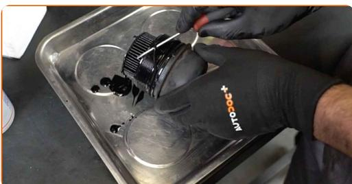
**23** Lösen Sie den Ölfilter vom Filterdeckel.
