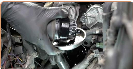
**Austausch: Motoröl und Ölfilter – Ford Focus MK2 diesel. Tipp:**
