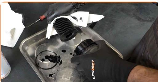
**24** Reinigen Sie den Deckel des Ölfilter-Gehäuses. Verwenden Sie Allzweckreinigungsspray.
