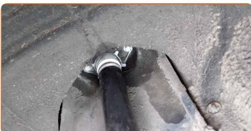
25 Entfernen Sie den Träger unter dem hinteren Arm.
