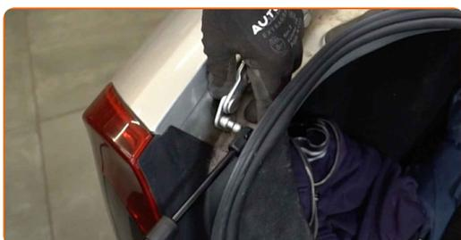
**Austausch: Heckklappendämpfer – Ford Focus MK2. AUTODOC-Experten empfehlen:**
