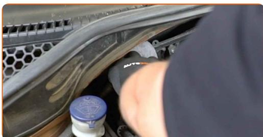
**7** Reinigen Sie die Abdeckung und das Gehäuse des Luftfilters.
