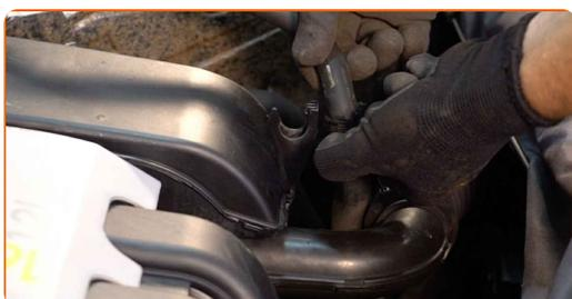
**4** Trennen Sie das Luftansaugrohr vom Luftfilter-Gehäuse.
