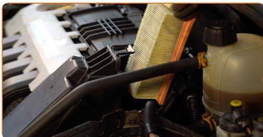
**8** Setzen Sie ein neues Filterelement in das Filtergehäuse. Stellen Sie sicher, dass die Filterkante dicht am Gehäuse ansitzt.
