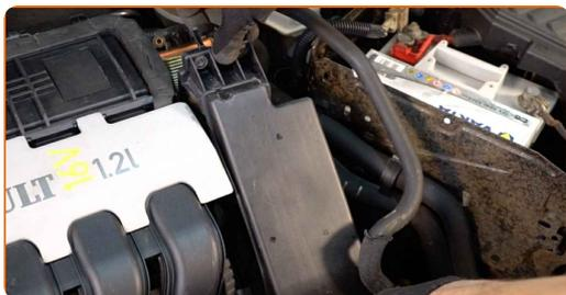
**7** Entfernen Sie das Filterelement aus dem Filtergehäuse.
