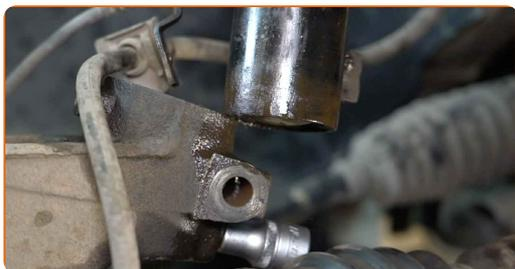
**32** Schrauben Sie das obere Befestigungselement des Federbeins ab.
