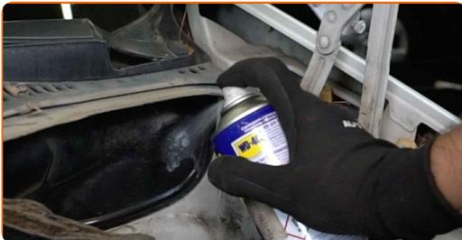
**5** Lösen Sie die Befestigungen von der Spritzschutzwand/Wasserwanneabdeckung. Verwenden Sie Stecknuss Nr. 10. Verwenden Sie einen Ratschenschlüssel.
