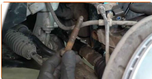
**30** Lösen Sie das untere Befestigungselement, dass das Federbein mit dem Achsschenkel verbindet. Verwenden Sie eine spezielle Schraubnuss, um den Stoßdämpfer zu entfernen. Verwenden Sie einen Ratschenschlüssel.
