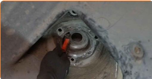
**52** Installieren Sie das Federbein am Radlauf.
