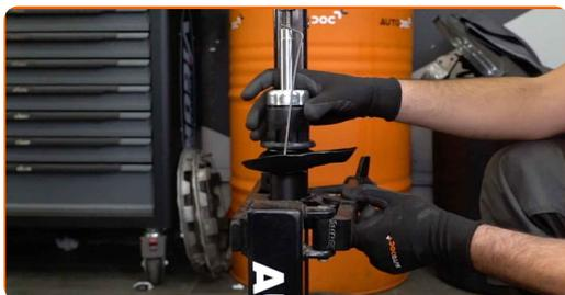
**44** Installieren Sie die Feder am Stoßdämpfer.
