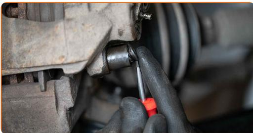
**15** Schrauben Sie die Befestigung des Bremssattels ab. Use HEX No.H8. Verwenden Sie einen Ratschenschlüssel.
