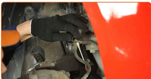
**11** Lösen Sie den Bremsschlauch vom Federbein.
