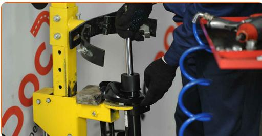
**31** Installieren Sie die Feder am Stoßdämpfer.
