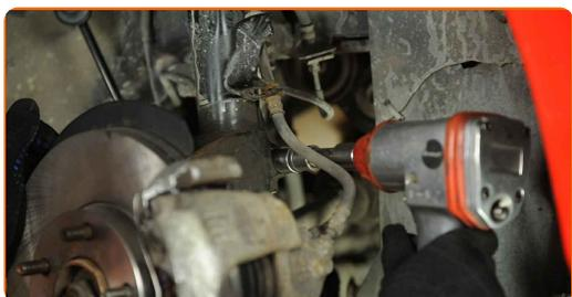
**14** Entfernen Sie die Befestigungsschraube.
