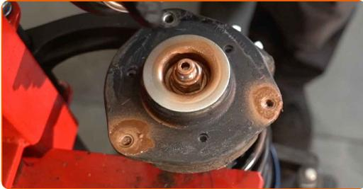
**37** Entfernen Sie das zusammengebaute Federbein.
