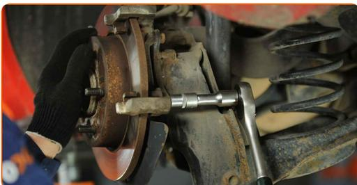
**16** Entfernen Sie die Befestigungsschrauben (2 Stück).
