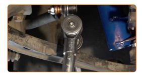
Ziehen Sie das Befestigungselement an, das die Druckstange mit dem Stabilisator verbindet. Verwenden Sie Ring-Gabelschlüssel Nr. 17. Verwenden Sie Stecknuss Nr. 17. Verwenden Sie einen Drehmomentschlüssel. Ziehen Sie ihn mit 59 Nm Drehmoment fest.
