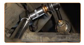
Entfernen Sie den Träger unter dem Arm.
