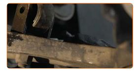
Schrauben Sie das Befestigungselement heraus, das die Druckstange mit dem Stabilisator verbindet. Verwenden Sie Ring-Gabelschlüssel Nr. 16. Verwenden Sie Stecknuss Nr. 16. Verwenden Sie einen Ratschenschlüssel.
