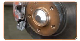
Die Bremsscheibenoberfläche reinigen. Benutzen Sie einen Bremsenreiniger.
