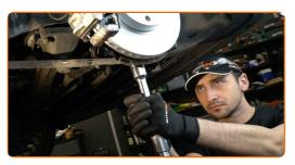
Ziehen Sie das Befestigungselement an, das den Stabilisator mit dem Querlenker verbindet. Verwenden Sie Ring-Gabelschlüssel Nr. 17. Verwenden Sie Stecknuss Nr. 17. Verwenden Sie einen Drehmomentschlüssel. Ziehen Sie ihn mit 42 Nm Drehmoment fest.
