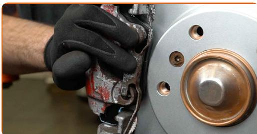
**30** Ziehen Sie die Bremssattelbefestigungen fest. Verwenden Sie Inbusschlüssel Nr. H7. Verwenden Sie einen Drehmomentschlüssel. Ziehen Sie ihn mit 30 Nm Drehmoment fest.
