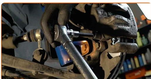
**31** Installieren Sie die Staubschutzkappen der Bremssattel-Führungsstifte.
