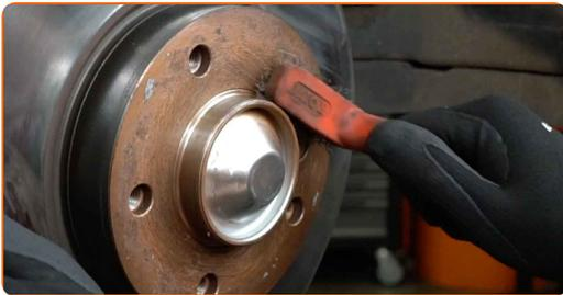
**17** Lösen Sie die Befestigung der Brems Scheibe. Verwenden Sie Inbusschlüssel Nr. H5. Verwenden Sie einen Schlagschrauber.
