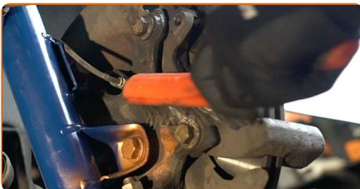
**14** Lösen Sie die Befestigung der Sattelhalterung. Verwenden Sie Stecknuss Nr. 16. Verwenden Sie ein Windeisen.
