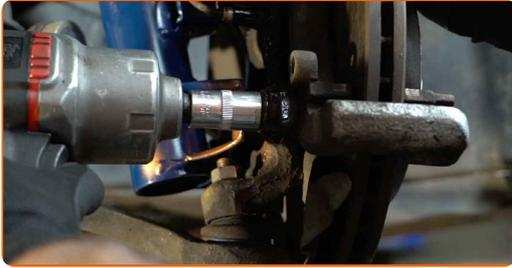
**15** Entfernen Sie die Sattelhalterung.
