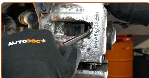
**7** Die Befestigungselemente der Bremssattelhalterung reinigen. Benutzen Sie eine Drahtbürste. Benutzen Sie WD-40-Spray.
