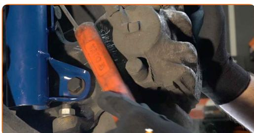
**8** Lösen Sie die Befestigung der Sattelhalterung. Verwenden Sie Stecknuss Nr. 16. Verwenden Sie ein Windeisen.
