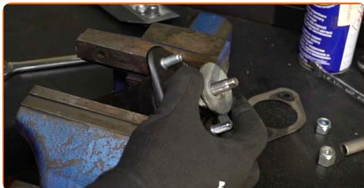
**22** Ziehen Sie die Mutter der Stoßdämpferkolbenstange fest. Verwenden Sie Stecknuss Nr. 16. Verwenden Sie einen Stoßdämpfer Steckschlüsseleinsatz DDN<sup>®</sup>6 Verwenden Sie einen Drehmomentschlüssel. Ziehen Sie ihn mit 37 Nm Drehmoment fest.
