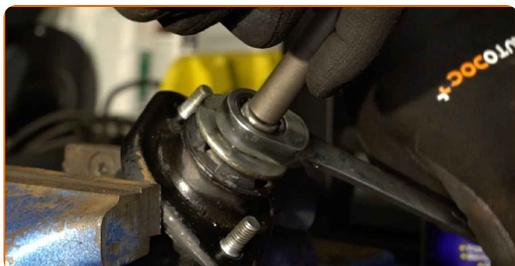
**20** Entfernen Sie den oberen Halter des Stoßdämpfers.
