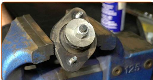
**18** Reinigen Sie die Befestigungen vom Stoßdämpferschaft. Benutzen Sie eine Drahtbürste. Benutzen Sie WD-40-Spray.
