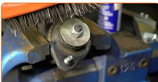
**19** Entfernen Sie die Befestigung der Stoßdämpferkolbenstange. Verwenden Sie einen Stoßdämpfer Steckschlüsseinsatz DDN#6. Verwenden Sie Stecknuss Nr. 16. Verwenden Sie einen Ratschenschlüssel.
