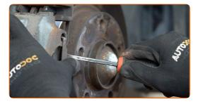
11 Entfernen Sie den Bremssattel.
