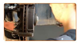
15 Entfernen Sie die Sattelhalterung.
