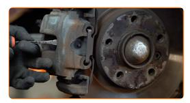
Entfernen Sie die Staubschutzkappen der Bremssattel-Führungsstifte. Benutzen Sie ein Brecheisen.
