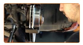
Reinigen Sie den Montageort von Bremssattel sowie seiner Halterung. Benutzen Sie eine Drahtbürste. Benutzen Sie einen Bremsenreiniger.
