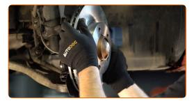
Ziehen Sie die Befestigung der Bremsscheibe fest. Verwenden Sie den Torx T30. Verwenden Sie einen Drehmomentschlüssel. Ziehen Sie ihn mit 16 Nm Drehmoment fest.
