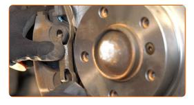
Die Bremsscheibenoberfläche reinigen. Benutzen Sie einen Bremsenreiniger.
