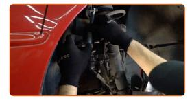
Bringen Sie die Bremsbeläge im Bremssattel an.
