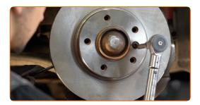
Setzen Sie die Halterung des Bremssattels ein.
