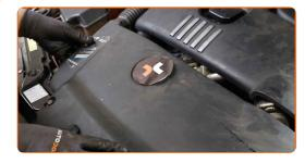
Schraube die Befestigungselemente des Lüftungskanals ein. Verwenden Sie Stecknuss Nr. 12. Verwenden Sie einen Ratschenschlüssel.
