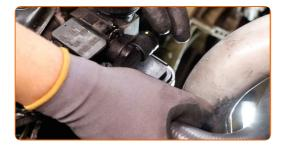
Befestigen Sie die Halterungen des Kühlmittelschlauchs.
