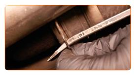
Lösen Sie den Kühlmittelschlauch. Benutzen Sie ein Brecheisen.
