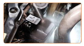
Schließen Sie den neuen Kühlmittelschlauch an.
