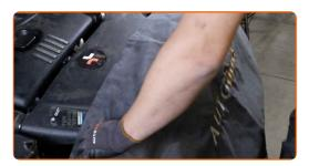
Löse die Befestigungen des Lüftungskanals ab. Verwenden Sie Stecknuss Nr. 12. Verwenden Sie einen Ratschenschlüssel.
