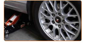
Entfernen Sie den Wagenheber sowie die Unterlegkeile.
