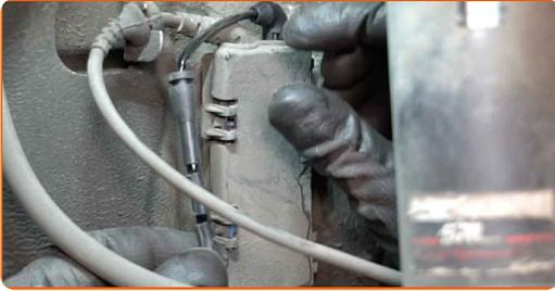
15 Bauen Sie den Verschleißsensor auf den Bremsbelägen ein. Verwenden Sie eine Rundzange.
