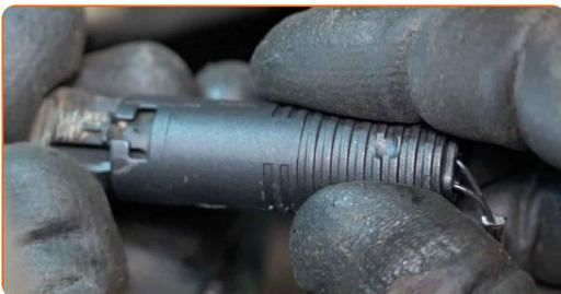
13 Bringen Sie das Kabel des Bremsbelagverschleißsensors an.
