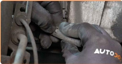
11 Behandeln Sie den Stecker des Bremsbelagverschleißsensors. Verwenden Sie dielektrisches Fett.
