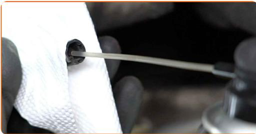
12 Bringen Sie den Steckverbinder des Verschleißsensors der Bremsbeläge an.
