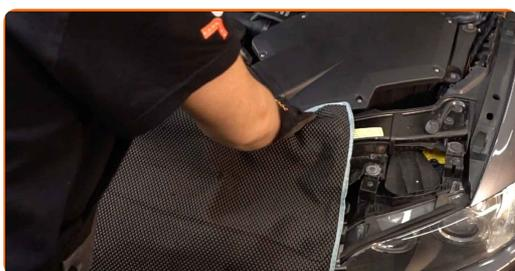
**3** Lösen Sie die Befestigungsschrauben der Luftfilter-Abdeckung. Verwenden Sie den Torx T25. Verwenden Sie einen Ratschenschlüssel.
