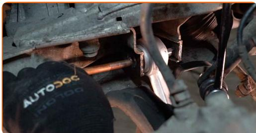
**19** Verbinden Sie den Unterarm mit dem Achsschenkel.
