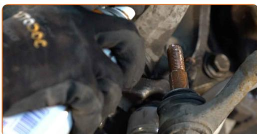
**22** Bauen Sie den Spurstangenkopf an dem Achsschenkel an.
