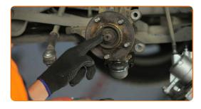
Lösen Sie das Befestigungselement, welches die Antriebswelle mit der Radnabe verbindet. Verwenden Sie Stecknuss Nr. 32. Verwenden Sie einen Ratschenschlüssel.
