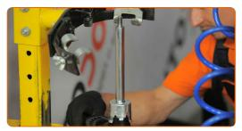
Installieren Sie die Feder am Stoßdämpfer.
