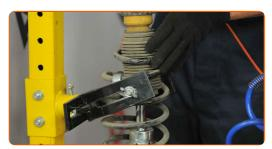
Bauen Sie das Domlager und das Federbeinstützlager ein. Verwenden Sie Inbusschlüssel Nr. H5.
