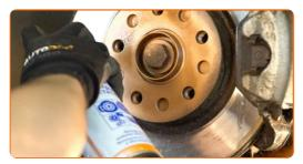
Die Bremsscheibenoberfläche reinigen. Benutzen Sie einen Bremsenreiniger.
