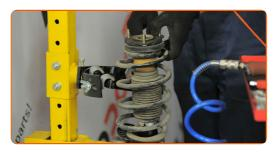
Installieren Sie das Federbein am Radlauf.
