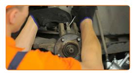
Reinigen Sie das Befestigungselement der Antriebswelle. Benutzen Sie eine Drahtbürste. Benutzen Sie WD-40-Spray.
