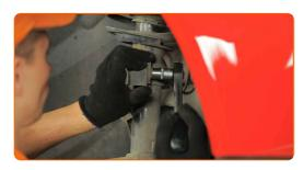
Ziehen Sie den Bremsschlauch Halterung ab.
