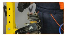
Ziehen Sie die Federbeinkolbenstangenmutter an. Verwenden Sie einen flachen Schraubendreher. Verwenden Sie Stecknuss Nr. 18. Verwenden Sie einen Drehmomentschlüssel. Ziehen Sie ihn mit 58 Nm Drehmoment fest.
