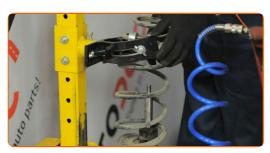
Entnehmen Sie den alten Stoßdämpfer aus dem hydraulischen Spiralfederspanner.
