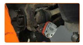
Ziehen Sie die unteren Befestigungen an, die das Federbein mit dem Achsschenkel verbinden. Verwenden Sie Stecknuss Nr. 15. Verwenden Sie einen Drehmomentschlüssel. Ziehen Sie ihn mit 83 Nm Drehmoment fest.
