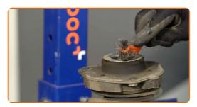
Entfernen Sie die Stangenmutter des Federkolben. Verwenden Sie einen flachen Schraubendreher. Verwenden Sie Stecknuss Nr. 18. Verwenden Sie einen Ratschenschlüssel.
