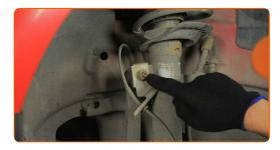
Schrauben Sie das Befestigungselement heraus, das die Druckstange mit dem Federbein verbindet. Verwenden Sie Ring-Gabelschlüssel Nr. 17. Verwenden Sie Inbusschlüssel Nr. H5. Verwenden Sie einen Ratschenschlüssel.
