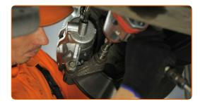
Bauen Sie den Spurstangenkopf an dem Achsschenkel an.
