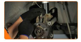
Montieren Sie den Querlenker.
