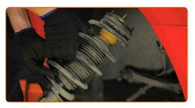
Stellen Sie das Dämpferbein auf das Federspannwerkzeug.
