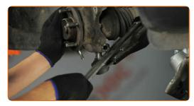
Entfernen Sie die Gelenkwelle von der Radnabe. Verwenden Sie einen Splintentreiber. Benutzen Sie einen Hammer.
