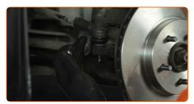
Ziehen Sie die Befestigungsmutter an, die den Spurstangenkopf mit dem Achsschenkel verbindet. Verwenden Sie Stecknuss Nr. 17. Verwenden Sie einen Drehmomentschlüssel. Ziehen Sie ihn mit 40 Nm Drehmoment fest.
