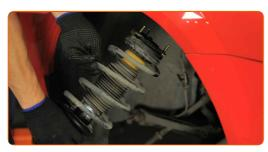
Schrauben Sie die obere Befestigung des Federbeinbefestigung an.
