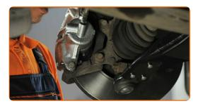
Lösen Sie die Befestigung der Sattelhalterung. Verwenden Sie Stecknuss Nr. 17. Verwenden Sie einen Ratschenschlüssel.
