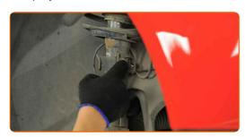
Schrauben Sie den Bremsschlauch-Befestigungswinkel aus dem Federbein heraus. Verwenden Sie Stecknuss Nr. 15. Verwenden Sie einen Ratschenschlüssel.
