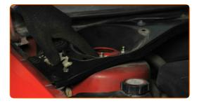
Lösen Sie die obere Befestigung der Federbeinbefestigung. Verwenden Sie Stecknuss Nr. 13. Verwenden Sie einen Ratschenschlüssel.
