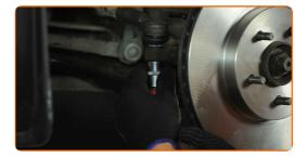
Behandeln Sie das Befestigungselement, das den Spurstangenkopf mit dem Achsschenkel verbindet. Benutzen Sie ein Kupferschmiermittel.
