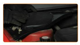
Entfernen Sie die Kotflügel-Abdeckung.
