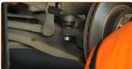
**17** Behandeln Sie das Befestigungselement, das den Spurstangenkopf mit dem Achsschenkel verbindet. Benutzen Sie ein Kupferschmiermittel.
