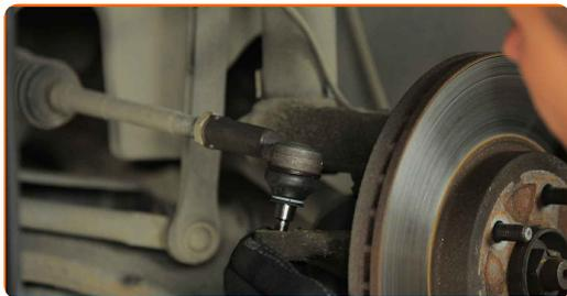
**16** Ziehen Sie die Befestigungsmutter an, die den Spurstangenkopf mit dem Achsschenkel verbindet. Verwenden Sie Stecknuss Nr. 15. Verwenden Sie einen Drehmomentschlüssel. Ziehen Sie ihn mit 40 Nm Drehmoment fest.
