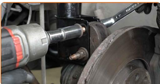
**35** Ziehen Sie die unteren Befestigungen an, die das Federbein mit dem Achsschenkel verbinden. Verwenden Sie Ring-Gabelschlüssel Nr. 18. Verwenden Sie Stecknuss Nr. 18. Verwenden Sie einen Drehmomentschlüssel. Ziehen Sie ihn mit 90 Nm Drehmoment fest.
