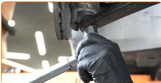
**40** Behandeln Sie die Befestigungen des Kugelgelenks. Behandeln Sie die Federbein-Befestigungen. Benutzen Sie ein Kupferschmiermittel.
