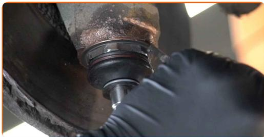
**25** Ziehen Sie die Sicherungsmutter des Traggelenks fest. Benutzen Sie ein Brecheisen.
