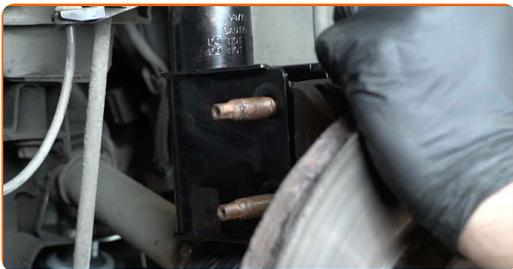
**34** Schrauben Sie das Befestigungselement ein, das das Federbein mit dem Achsschenkel verbindet. Verwenden Sie Ring-Gabelschlüssel Nr. 18. Verwenden Sie Stecknuss Nr. 18. Verwenden Sie einen Ratschenschlüssel.
