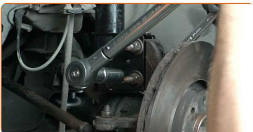
**36** Die Antriebswellenmutter festziehen. Verwenden Sie Stecknuss Nr. 36. Verwenden Sie einen Drehmomentschlüssel. Ziehen Sie ihn mit 280 Nm Drehmoment fest.
