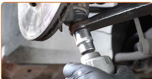
**39** Ziehen Sie das Kugelgelenk an. Verwenden Sie Stecknuss Nr. 21. Verwenden Sie einen Drehmomentschlüssel. Ziehen Sie ihn mit 50 Nm Drehmoment fest.
