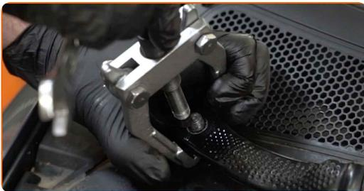
**6** Schrauben Sie die Befestigungen des Bremsflüssigkeitsbehälters ab. Verwenden Sie den Torx T20. Verwenden Sie einen Ratschenschlüssel.
