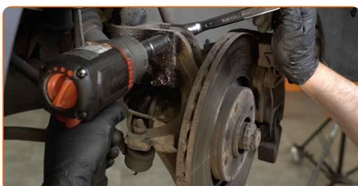
**26** Entfernen Sie die Befestigungsschraube.
