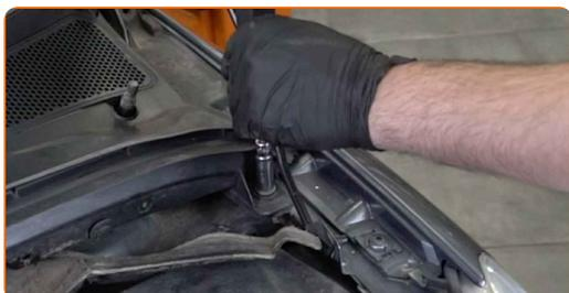
**76** Bringen Sie die Befestigungselemente der Windlaufabdeckung an.
