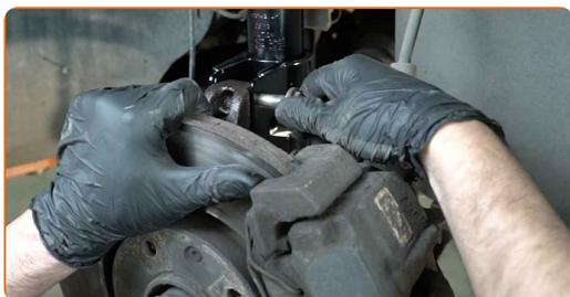
**56** Entfernen Sie den Träger unter dem Achsschenkel.
