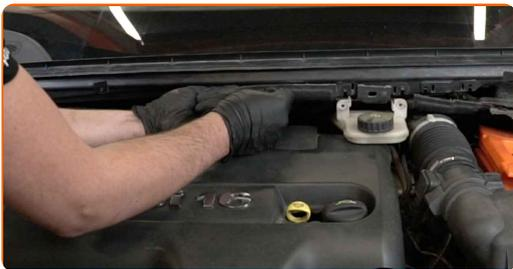
**77** Ziehen Sie die Befestigungen des Bremsflüssigkeitsbehälters fest. Verwenden Sie den Torx T20. Verwenden Sie einen Ratschenschlüssel.
