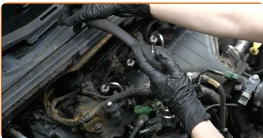
**9** Entfernen Sie die mit einer alten Filterkartusche zusammengebauten Kraftstofffilterabdeckung.
