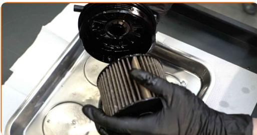
**15** Reinigen Sie die Abdeckung und das Gehäuse des Kraftstofffilters. Verwenden Sie Allzweckreinigungsspray.
