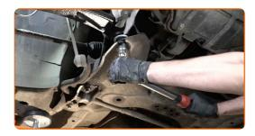
Schrauben Sie die hinteren Befestigungen, welche den Querlenker mit dem Karosseriehilfsrahmen verbinden, fest. Verwenden Sie Stecknuss Nr. 21. Verwenden Sie einen Drehmomentschlüssel. Ziehen Sie ihn mit 111 Nm Drehmoment fest.
