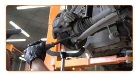
Entfernen Sie den Träger unter dem Achsschenkel.
