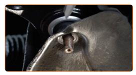
Schrauben Sie die vordere Armbefestigung an. Verwenden Sie den Torx T50. Verwenden Sie Stecknuss Nr. 21. Verwenden Sie einen Ratschenschlüssel.
