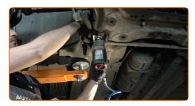
Lösen Sie die hintere Befestigung des Querlenkers.
