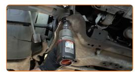
Entfernen Sie die vordere Befestigung des Querlenkers. Verwenden Sie einen Splintentreiber. Benutzen Sie einen Hammer.
