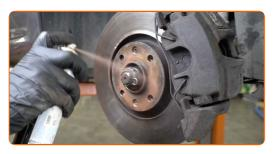
Die Bremsscheibenoberfläche reinigen. Benutzen Sie einen Bremsenreiniger.
