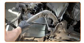
Reinigen Sie die Montagebohrungen und die Gewinde des Querlenkers. Benutzen Sie eine Drahtbürste. Benutzen Sie WD-40-Spray.
