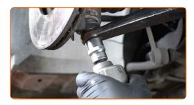
Ziehen Sie das Kugelgelenk an. Verwenden Sie Stecknuss Nr. 21. Verwenden Sie einen Drehmomentschlüssel. Ziehen Sie ihn mit 50 Nm Drehmoment fest.
