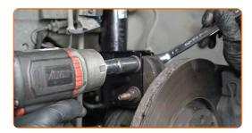
Ziehen Sie die unteren Befestigungen an, die das Federbein mit dem Achsschenkel verbinden. Verwenden Sie Ring-Gabelschlüssel Nr. 18. Verwenden Sie Stecknuss Nr. 18. Verwenden Sie einen Drehmomentschlüssel. Ziehen Sie ihn mit 90 Nm Drehmoment fest.
