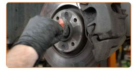
Entfernen Sie den Splint der Mutter der Antriebswelle. Verwenden Sie einen Splintentreiber.
