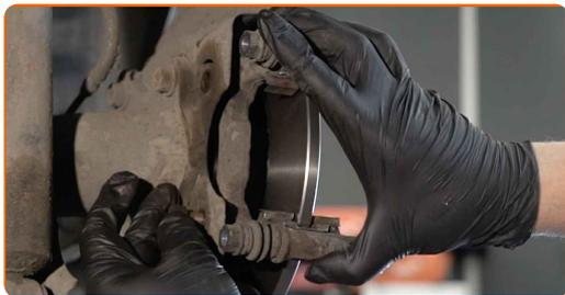
**32** Befestigen Sie die Bremssattelhalterung. Verwenden Sie den Torx T50. Verwenden Sie einen Drehmomentschlüssel. Ziehen Sie ihn mit 53 Nm Drehmoment fest.
