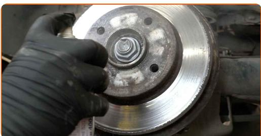
**20** Schrauben Sie die Radnaben-Achsmutter ab. Verwenden Sie Stecknuss Nr. 32. Verwenden Sie ein Windeisen.
