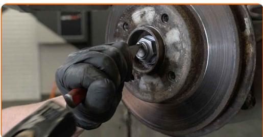
**19** Reinigen Sie das Befestigungselement der Radnabe. Benutzen Sie WD-40-Spray.
