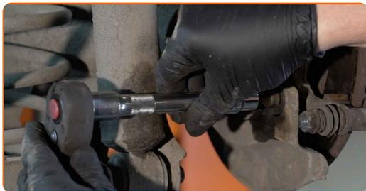
**14** Entfernen Sie die Sattelhalterung.
