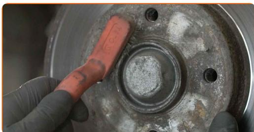
**16** Entfernen Sie die Schutzkappe des Nabenlagers. Benutzen Sie einen Hammer. Benutzen Sie ein Brecheisen.
