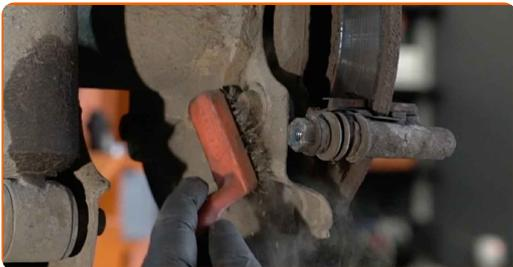
**13** Lösen Sie die Befestigung der Sattelhalterung. Verwenden Sie den Torx T50. Verwenden Sie ein Windeisen.
