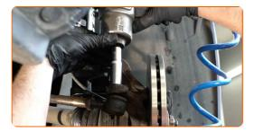
Ziehen Sie den Spurstangenkopf vom Achsschenkel. Verwenden Sie einen Kugelgelenkabzieher.
