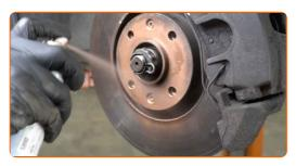
Die Bremsscheibenoberfläche reinigen. Benutzen Sie einen Bremsenreiniger.
