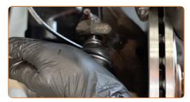
Schrauben Sie die Befestigungsmutter auf, die den Spurstangenkopf mit dem Achsschenkel verbindet. Verwenden Sie Stecknuss Nr. 17. Verwenden Sie einen Ratschenschlüssel.
