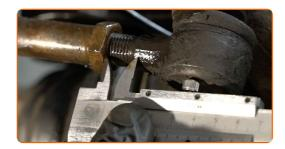
Lösen Sie die Kontermutter des Spurstangenkopf und der Zugstange. Verwenden Sie Ring-Gabelschlüssel Nr. 16. Verwenden Sie Ring-Gabelschlüssel Nr. 22.
