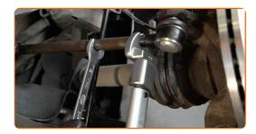
Beim Deinstallieren sollten Sie die genaue Position des Kugelgelenks an der Spurstange markieren oder messen - oder zählen Sie die Anzahl der Windungen, um danach eine Fehlausrichtung zu vermeiden. Verwenden Sie einen Messschieber.
