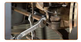
Lösen Sie das Ende der Befestigungsmutter an dem Achsschenkel. Verwenden Sie Stecknuss Nr. 16. Verwenden Sie ein Windeisen.
