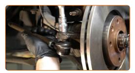
Ziehen Sie die Befestigungsmutter an, die den Spurstangenkopf mit dem Achsschenkel verbindet. Verwenden Sie Stecknuss Nr. 17. Verwenden Sie einen Drehmomentschlüssel. Ziehen Sie ihn mit 35 Nm Drehmoment fest.
