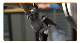
Reinigen Sie die Montagesitze des Spurstangenkopfes. Benutzen Sie eine Drahtbürste. Benutzen Sie WD-40-Spray.
