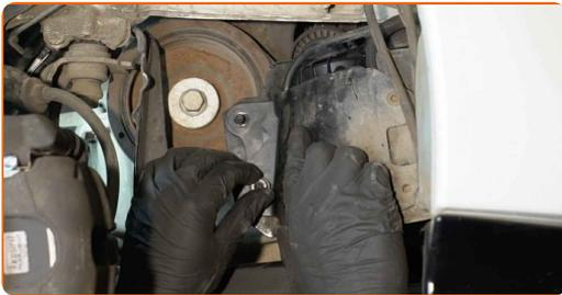
**23** Schrauben Sie die Befestigungsbolzen der Treibstofffilterhalterung an. Verwenden Sie Stecknuss Nr. 13. Verwenden Sie einen Ratschenschlüssel.
