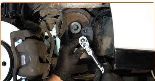
**10** Entfernen Sie den Befestigungswinkel des Kraftstofffilters.
