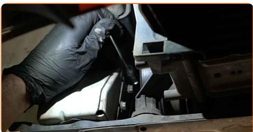
**12** Entfernen Sie den Befestigungswinkel des Kraftstofffilters.
