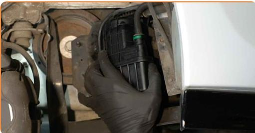
**21** Schrauben Sie die Befestigungsbolzen der Treibstofffilterhalterung an. Verwenden Sie Ring-Gabelschlüssel Nr. 10.
