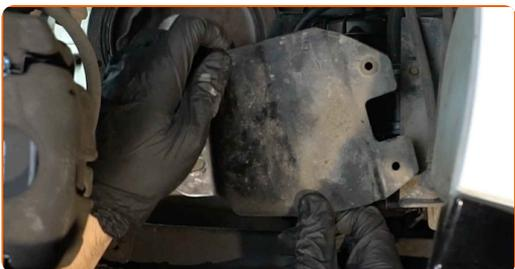
**11** Schrauben Sie die Befestigungsbolzen der Treibstofffilterhalterung ab. Verwenden Sie Ring-Gabelschlüssel Nr. 10.
