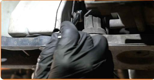
**22** Installieren Sie den Befestigungswinkel des Kraftstofffilters.
