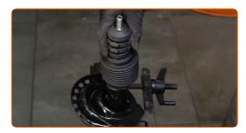
Installieren Sie die Feder am Stoßdämpfer.
