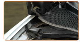
Schrauben Sie die Befestigungen der Abdeckung des Federbeinstützlagers ab. Verwenden Sie Stecknuss Nr. 10. Verwenden Sie einen Ratschenschlüssel.
