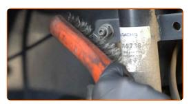
Schrauben Sie das Befestigungselement heraus, das die Druckstange mit dem Federbein verbindet. Verwenden Sie Stecknuss Nr. 16. Verwenden Sie einen Ratschenschlüssel.
