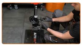
Installieren Sie die Staubschutzmanschette und den Anschlagpuffer auf dem neuen Stoßdämpfer.
