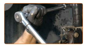
Ziehen Sie die unteren Befestigungen an, die das Federbein mit dem Achsschenkel verbinden. Verwenden Sie Ring-Gabelschlüssel Nr. 18. Verwenden Sie Stecknuss Nr. 18. Verwenden Sie einen Drehmomentschlüssel. Ziehen Sie ihn mit 105 Nm Drehmoment fest.
