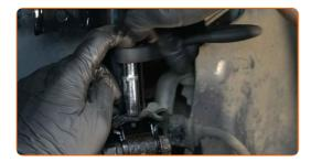
Verbinden Sie das ABS mit der Sensorverdrahtung.
