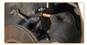
Schrauben Sie das Befestigungselement ein, das das Federbein mit dem Achsschenkel verbindet. Verwenden Sie Ring-Gabelschlüssel Nr. 18. Verwenden Sie Stecknuss Nr. 18. Verwenden Sie einen Ratschenschlüssel.
