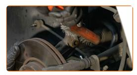
Befestigen Sie das Dämpferbein auf dem Achsschenkel.
