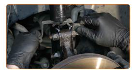
Ziehen Sie die Befestigungsklammer des Bremsschlauchs am Federbein an. Verwenden Sie Stecknuss Nr. 10. Verwenden Sie einen Ratschenschlüssel.
