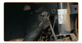
Trennen Sie die ABS Sensorverdrahtung. Benutzen Sie ein Brecheisen.
