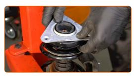
Ziehen Sie die Federbeinkolbenstangenmutter an. Verwenden Sie Stecknuss Nr. 18. Verwenden Sie Inbusschlüssel Nr. H6. Verwenden Sie einen Drehmomentschlüssel. Ziehen Sie ihn mit 62 Nm Drehmoment fest.
