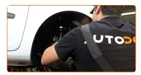
Schrauben Sie die obere Befestigung des Federbeinbefestigung an. Schrauben Sie diese nicht fest.
