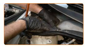
Schrauben Sie die Befestigungen der Abdeckung des Federbeinstützlagers ein. Verwenden Sie Stecknuss Nr. 10. Verwenden Sie einen Ratschenschlüssel.
