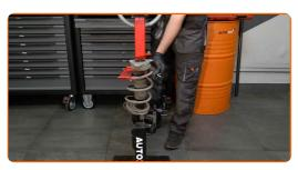
Behandeln Sie die Federbeinstange. Benutzen Sie eine Drahtbürste. Benutzen Sie WD-40-Spray.
