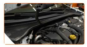
Entfernen Sie die Clips des Windlaufs. Verwenden Sie einen Lösehebel, um die Clips zu entfernen.
