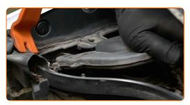
Reinigen Sie die Befestigungselemente der oberen Federbeinhalterung. Benutzen Sie eine Drahtbürste. Benutzen Sie WD-40-Spray.
