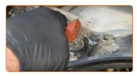
Lösen Sie die oberen Befestigungselemente des Federbeinstützlagers. Verwenden Sie Stecknuss Nr. 13. Verwenden Sie einen Ratschenschlüssel.
