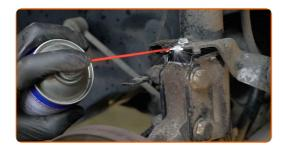
Schrauben Sie den Bremsschlauch-Befestigungswinkel aus dem Federbein heraus. Verwenden Sie Stecknuss Nr. 10. Verwenden Sie einen Ratschenschlüssel.
