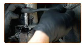
Ziehen Sie den Bremsschlauch Halterung ab.
