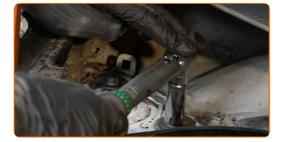
Behandeln Sie die Befestigungselemente des Federbeinstützlagers. Benutzen Sie ein Kupferschmiermittel.
