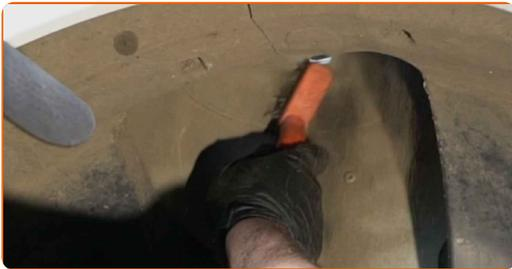
**40** Installieren Sie das Federbein am Radlauf.
