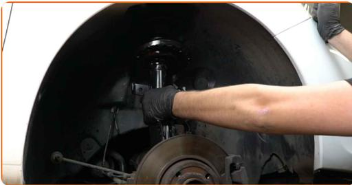
**41** Schrauben Sie die obere Befestigung des Federbeinbefestigung an. Schrauben Sie diese nicht fest.
