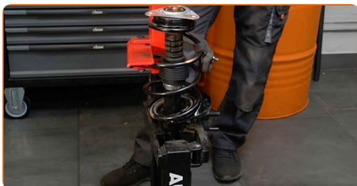
**38** Entfernen Sie das zusammengebaute Federbein.
