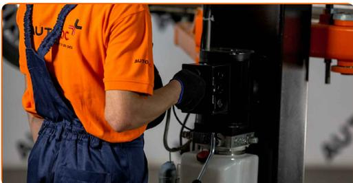
27 Stützen Sie den hinteren Querlenker. Benutzen Sie einen hydraulischen Getriebeheber.
