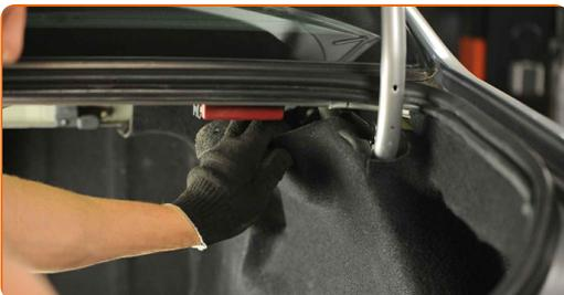
24 Bringen Sie die Clips der Seitenauskleidung des Kofferraums an.
