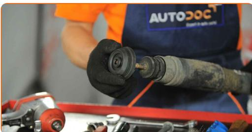
**20** Reinigen Sie die Stoßdämpferaufnahmen. Benutzen Sie eine Drahtbürste. Benutzen Sie WD-40-Spray.
