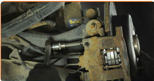
**8.2** Verwenden Sie Stecknuss Nr. 16. Verwenden Sie einen Ratschenschlüssel.
