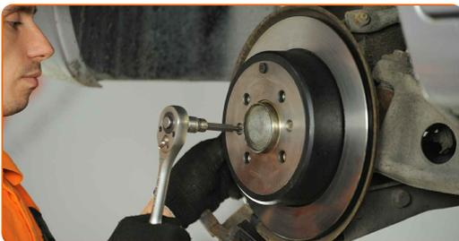
**14** Entfernen Sie die Bremsscheibe.
