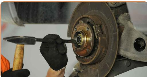
**17** Schrauben Sie die Radnaben-Achsmutter ab. Verwenden Sie Stecknuss Nr. 41. Verwenden Sie einen Ratschenschlüssel.
