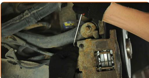
**8.1** Schrauben Sie die Befestigungen des Bremssattels ab. Verwenden Sie Inbusschlüssel Nr. H7.
