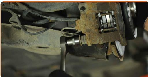
**32** Installieren Sie die Staubschutzkappen der Bremssattel-Führungsstifte.
