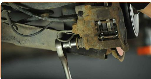
**9** Entfernen Sie die Befestigungsschrauben.
