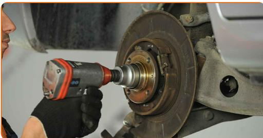
**18** Entfernen Sie die Befestigungsmutter.
