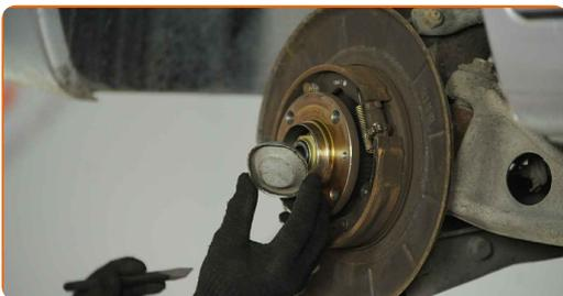
**16** Lösen Sie die Versteimmung der Radnabenmutter. Verwenden Sie einen flachen Metallmeißel. Benutzen Sie einen Hammer.
