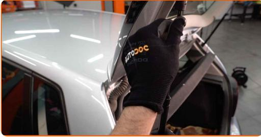
Austausch: Heckklappendämpfer – VW Polo 9N. AUTODOC empfiehlt:
