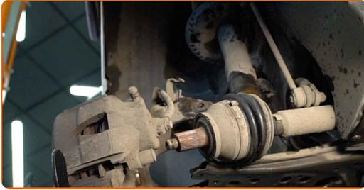
25 Schrauben Sie die untere Befestigung der Stoßdämpferstrebe ab.
