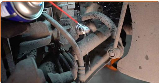
**14** Lösen Sie den Bremsschlauch vom Federbein. Verwenden Sie Stecknuss Nr. 12.
