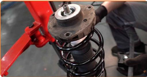
41 Installieren Sie das Federbein am Radlauf.
