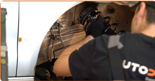
42 Sichern Sie die oberen Befestigungen des Federbeines. Schrauben Sie diese nicht fest.
