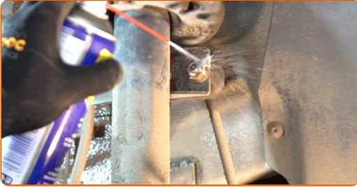
**12** Schrauben Sie die Mutter ab und entfernen Sie die Stabilisatorstange aus dem Federbein. Verwenden Sie Stecknuss Nr. 16. Verwenden Sie einen Ratschenschlüssel.
