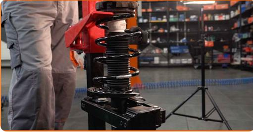
40 Entfernen Sie das zusammengebaute Federbein.
