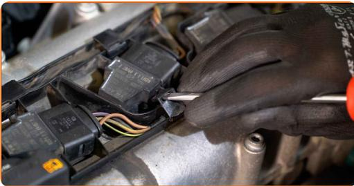
7 Heben Sie die Zündspule an. Verwenden Sie einen flachen Schraubendreher.
