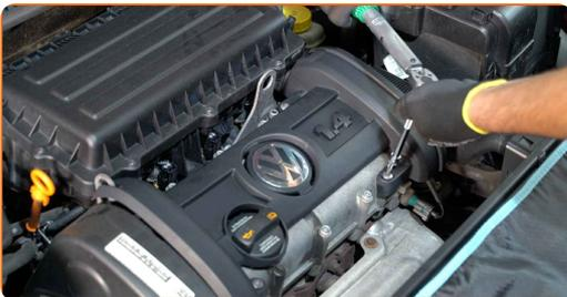
16 Verbinden Sie den Entlüftungsschlauch.
