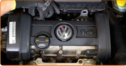
5 Entfernen Sie die Motorabdeckung. Verwenden Sie den Torx T30.
