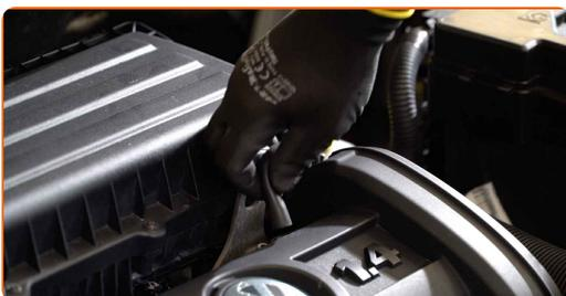
4 Lösen Sie die Schrauben der Motorabdeckung (4 Stück).
