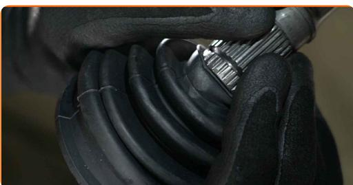
**33** Bringen Sie den Sicherungsring am Gleichlaufgelenk an.
