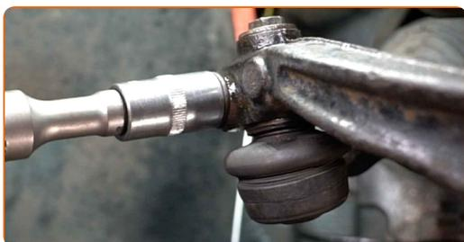
**46** Reinigen Sie die Montagebohrungen und die Gewinde des Querlenkers. Benutzen Sie eine Drahtbürste. Benutzen Sie WD-40-Spray.
