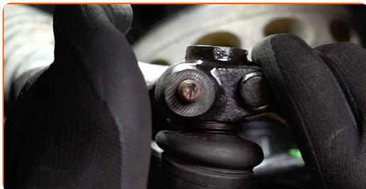
**43** Schrauben Sie die Befestigungsschraube des Spurstangenkopfs ein. Verwenden Sie Ring-Gabelschlüssel Nr. 13.
