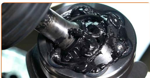
**37** Die Keilwellen des CV-Gelenks der Antriebswelle reinigen. Verwenden Sie Allzweckreinigungsspray.
