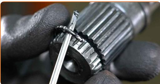
**32** Bringen Sie die Gleichlaufgelenkmanschette an der Antriebswelle an. Verwenden Sie einen flachen Schraubendreher.
