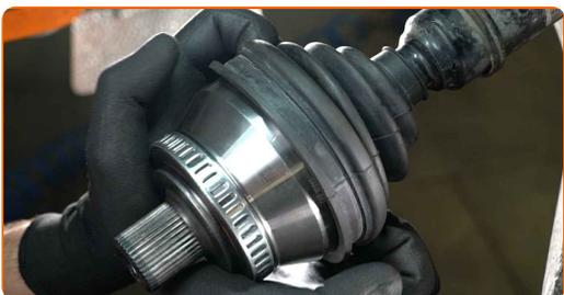
**39** Befestigen Sie die Klemmen der Gleichlaufgelenkmanschette. Verwenden Sie einen flachen Schraubendreher. Verwenden Sie eine Clic-R-Kragenzange. Benutzen Sie einen Hammer.
