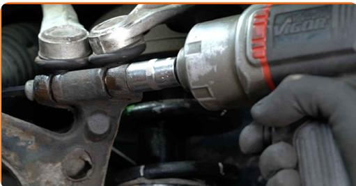
**13** Entfernen Sie die Befestigungsschraube.
