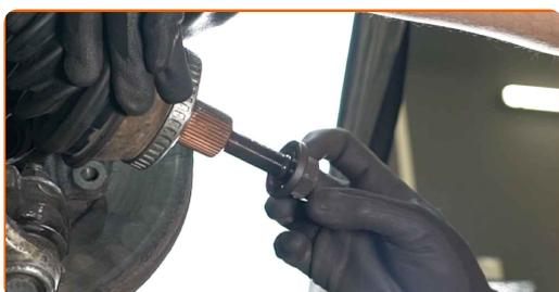
**28** Entfernen Sie das Gleichlaufgelenk zusammen mit seiner Manschette.
