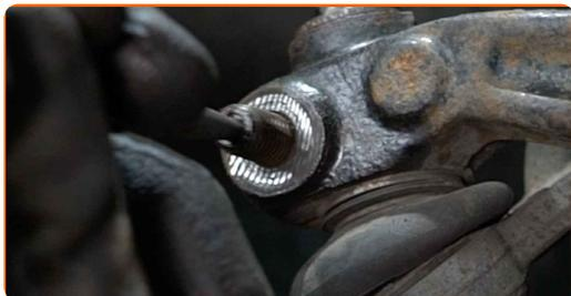
**14** Lockern Sie die Befestigungsschraube des Spurstangenkopfs. Verwenden Sie Stecknuss Nr. 13. Verwenden Sie einen Ratschenschlüssel.
