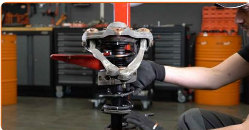
**56** Reinigen Sie die Anbringungssitze des Federbeins. Benutzen Sie eine Drahtbürste. Benutzen Sie WD-40-Spray.
