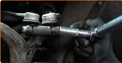
**82** Entfernen Sie den Träger unter dem Achsschenkel.
