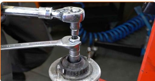
**40** Entfernen Sie das obere Federbeinlager. Benutzen Sie ein Brecheisen.
