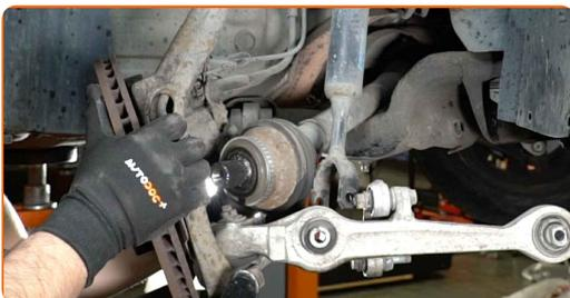
**29** Lösen Sie den unteren Bereich des Federbeins. Benutzen Sie ein Brecheisen.
