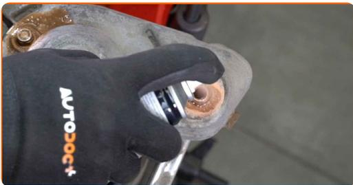
**55** Entfernen Sie das zusammengebaute Federbein.
