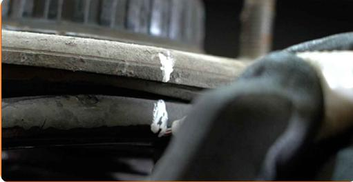
**38** Behandeln Sie die Federbeinstange. Benutzen Sie eine Drahtbürste. Benutzen Sie WD-40-Spray.
