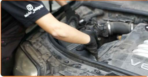
**30** Schraube die Befestigungselemente des Lüftungskanals ein. Verwenden Sie einen Kreuzschlitzschraubendreher.
